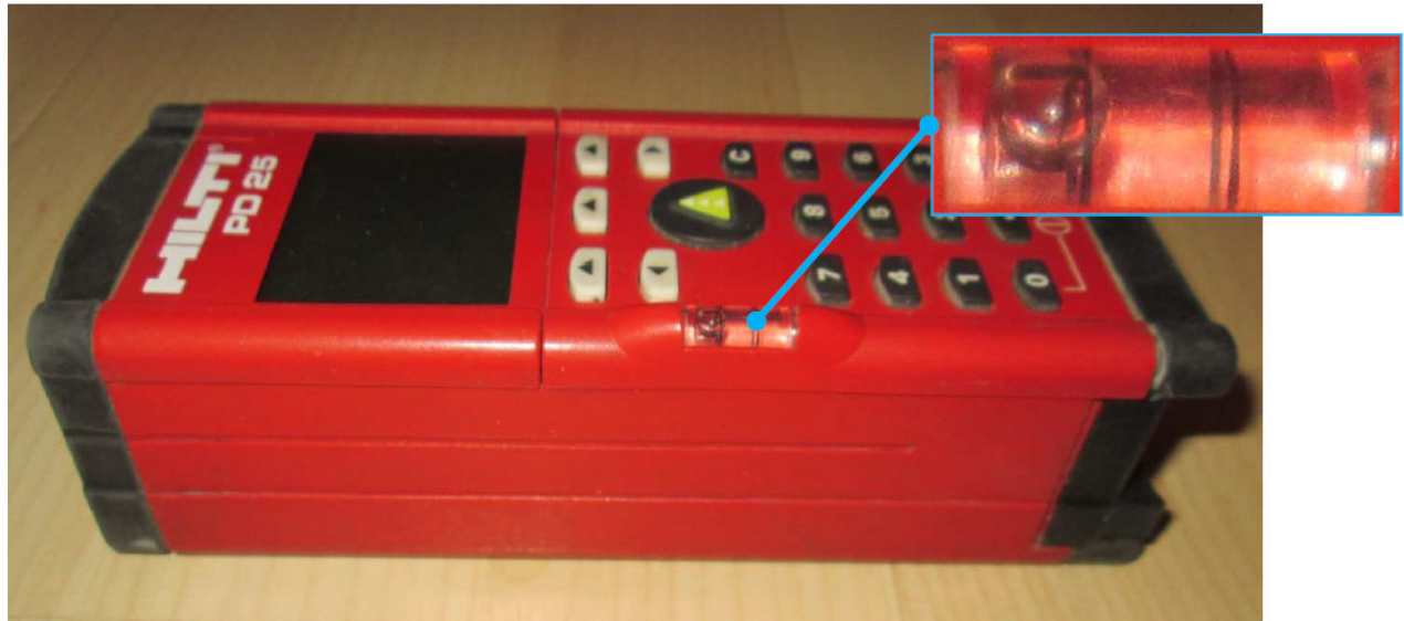
Bild 6: rund 6-7mm Höhenunterschied auf 15cm Länge
